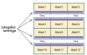
Abbildung 23. Beispielhafte Anordnung von 4 Abteilreihen mit nur zwei Gängen: Beachten Sie, dass die Längsseiten der Abteile entlang des Gangs sind.
