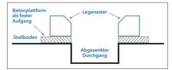
Abbildung 19. Beispiel eines Legenestsystems mit abgesenktem Durchgang
