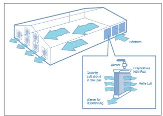
Abbildung 42. Pad-Kühlung mit Tunnellüftung
