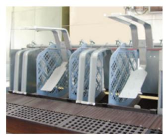
Abbildung 21. Beispiel eines automatischen Legenestsytems mit Rampen und "Abschiebemechanismus" (mit freundlicher Genehmigung von MGH)
